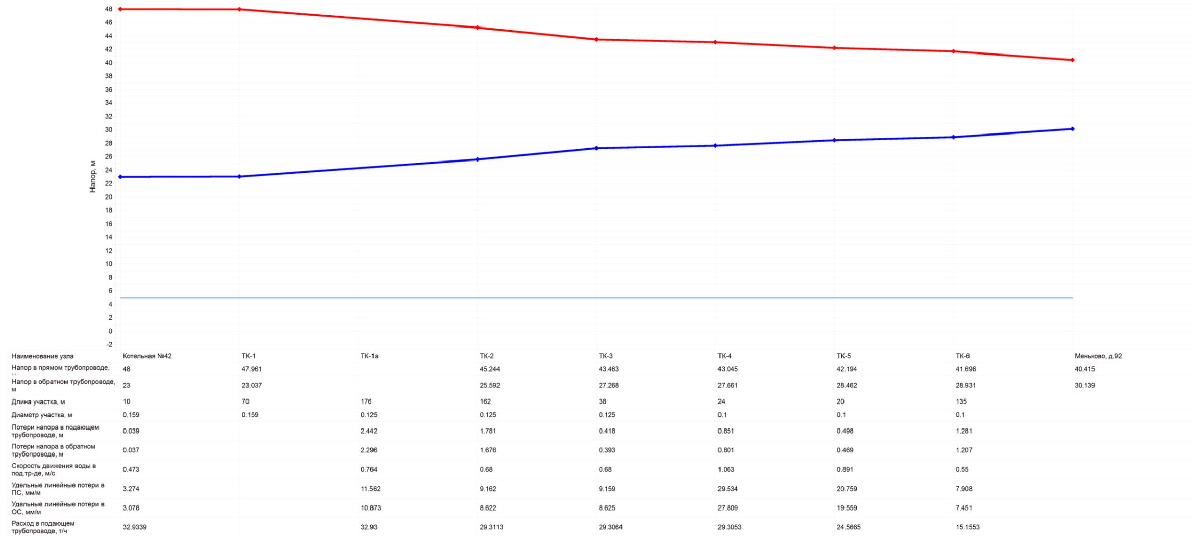
**Пьезометрический график контура отопления от котельной №42 дер. Меньково до дома №92**
