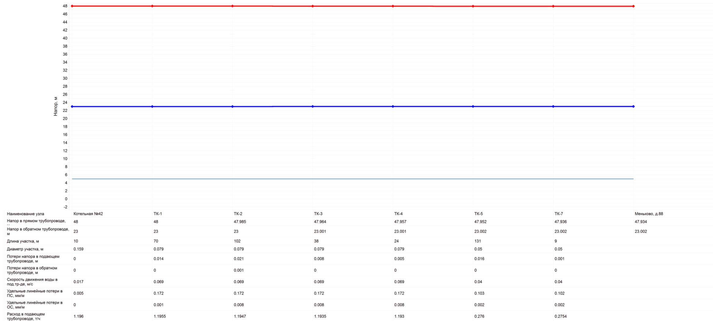
**Пьезометрический график контура ГВС от котельной №42 дер. Меньково до дома №88**
