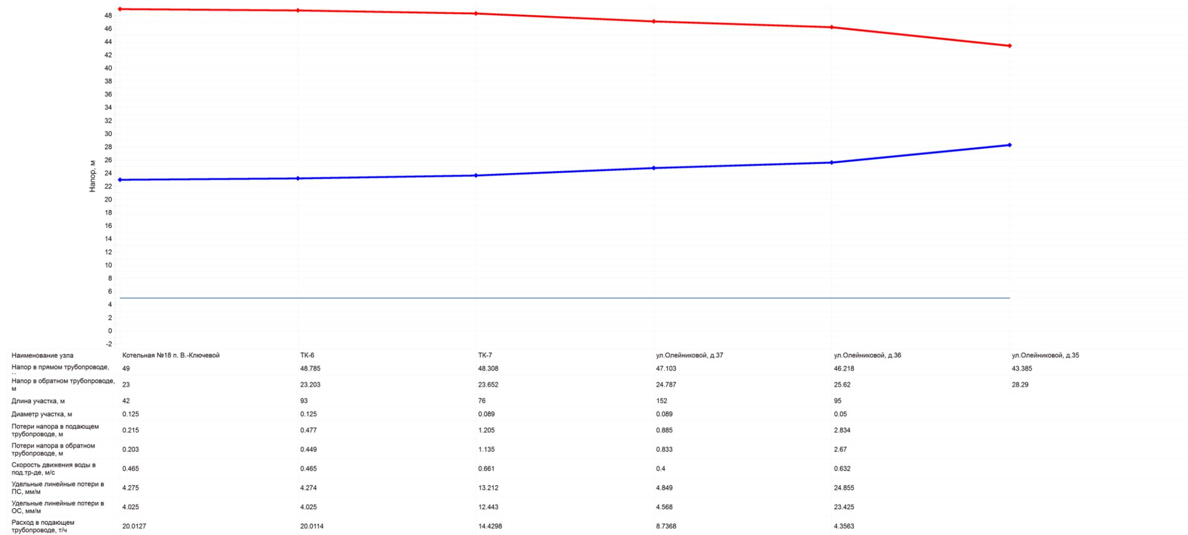
**Пьезометрический график контура отопления от котельной №18 пос. Высокоключевой до ул. Олейниковой, 35**
