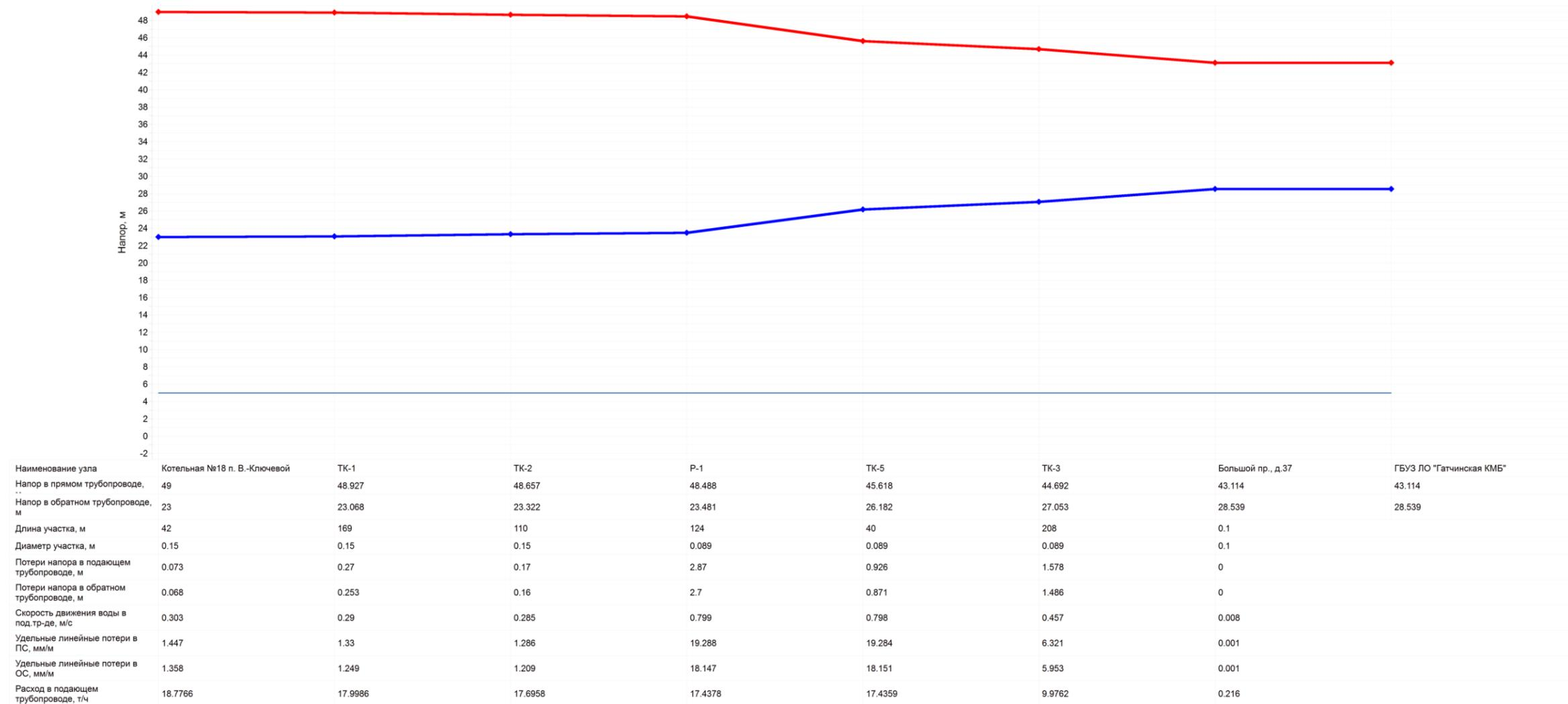
**Пьезометрический график контура отопления от котельной №18 пос. Высокоключевой до ГБУЗ ЛО ГКМБ**
